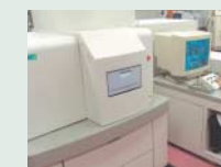
FIB装置 (集束イオンビーム加工装置) 用途: 試料の断面作成、観察
