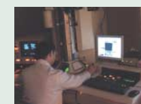
TEM装置 (透過型電子顕微鏡) 用途: 薄膜化した試料の断面拡大像、回折像観察
