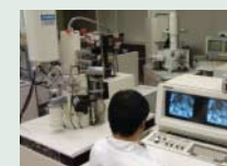
SEM装置 (走査型電子顕微鏡) 用途: 高倍率での表面形状観察
