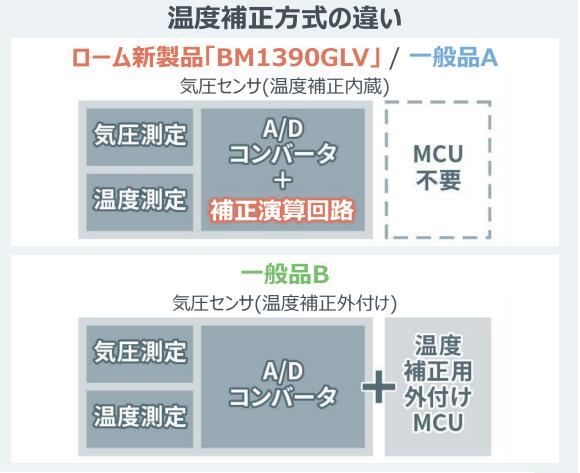
安定した気圧測定を実現、一般品では搭載が難しい熱源付近への搭載が可能外付けMCU(マイコン)での温度補正演算が不要なため、設計工数削減に貢献
