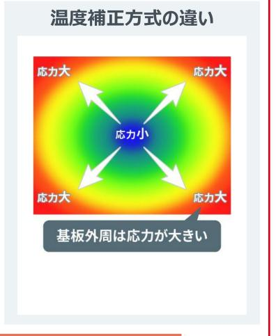
応力に強いセラミックパッケージを採用し、気圧測定の特性変動を抑制 基板レイアウト設計の自由度向上に貢献
