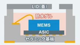
セラミック基板に平型の金属LIDで 蓋をする構造です。 特殊なゲルを充填し、 防水化を施しています。
