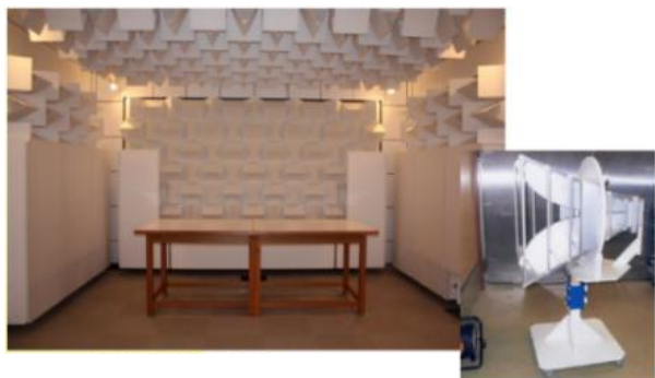
EMC測定用の電波暗室(YTC)
