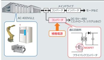
太陽光発電、工業用インバータ、半導体装置、試験装置などで高電圧入力対応の補機電源用途として最適です。
