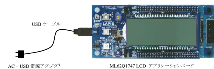
図 2 スタンドアロンでのシステム構成
