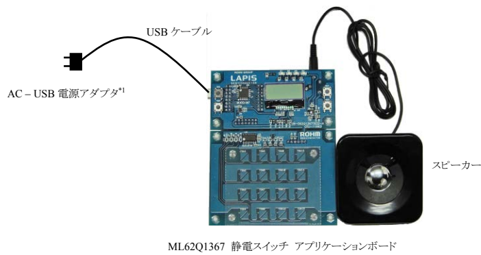
図 2 スタンドアロンでのシステム構成
