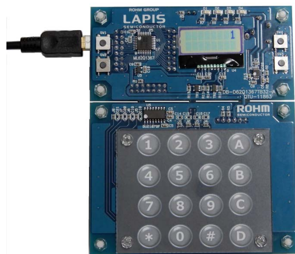
付録図1 DTMF サンプルプログラム キー配置シート装着時の ML62Q1367 静電スイッチアプリケーションボード
