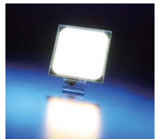
ローム出資のLumiotec社では、2010年2月より、照明用有機ELパネルのサンプル出荷を開始。本格的な量産・販売に向けて、準備を進めています。
