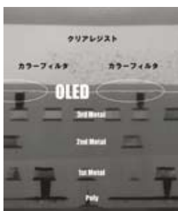
複合機能LSIの断面構造
