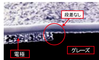
ステップフリー構造 SEM 断面写真
