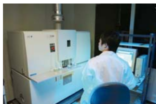
禁止物質の精密分析を可能とする誘導結合プラズマ発光分光分析装置 (ICP-AES)
