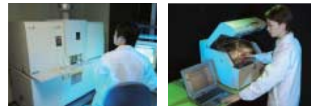
禁止物質の精密分析を可能とする誘導結合プラズマ発光分光分析装置 (ICP-AES) 蛍光X線分析装置 (XRF)
